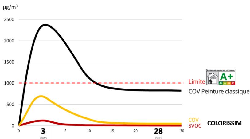
Source : Résultats des tests d'émission de COV et SVOC selon la norme ISO EN 16000 (en  $\mu\text{g}/\text{m}^3$ ). Scénario : murs peints en 2 couches, au rendement préconisé. Tests réalisés auprès du laboratoire EUROFINIS.
